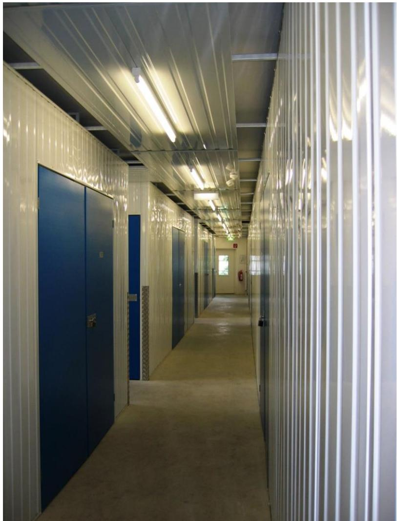
Die Mietflächen sind erfahrungsgemäß bis zu den raumabschließenden Bauteilen vollständig mit Lagergut gefüllt (hohe kompakte Brandlasten, die schlecht mit einem löschfähigen Strahl zu erreichen sind).
