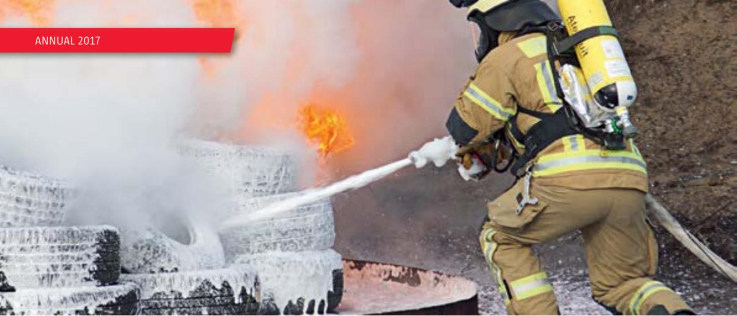
Löschversuch mit Druckluftschäum an brennenden Reifen
