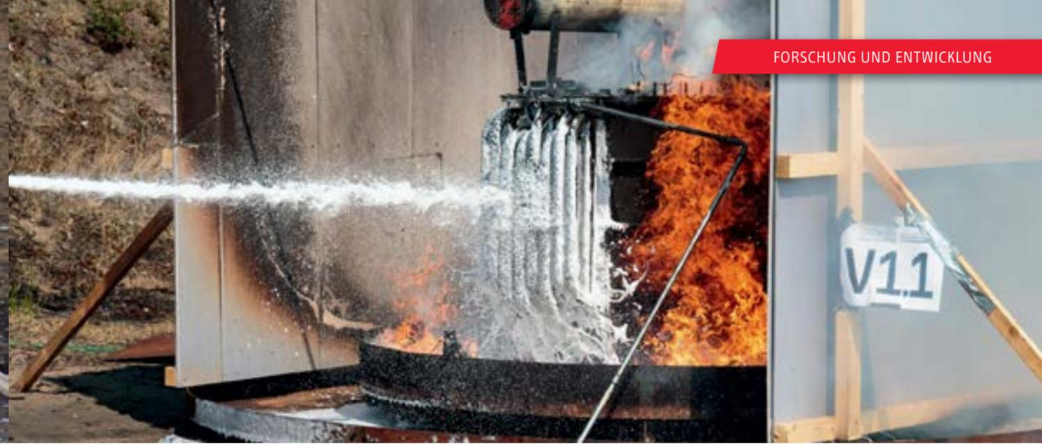
Löschversuch an einem Öltransformator
