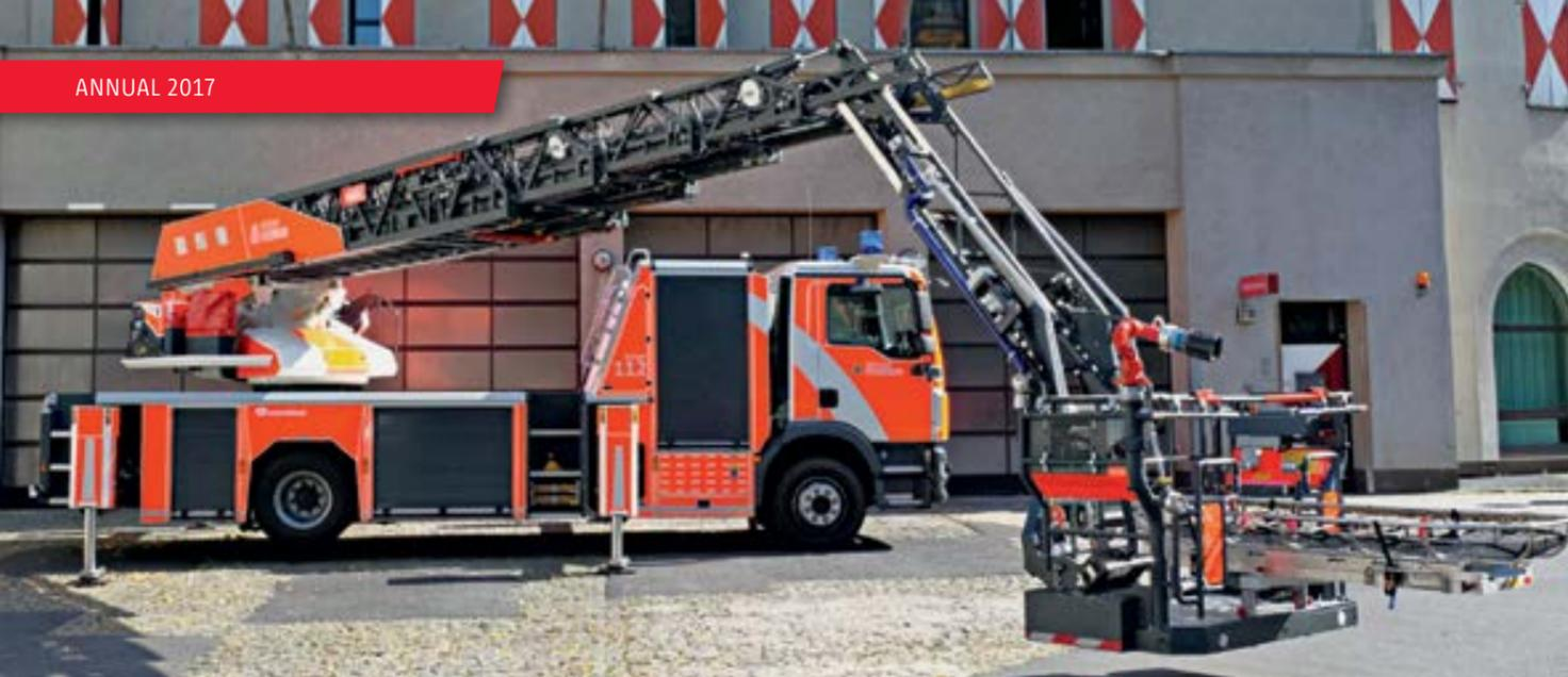
DLK mit Gelenkarm und montierter Schwerlastkrankentrage
