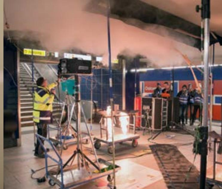
Versuchsaufbau zur Ermittlung der Rauchausbreitung
