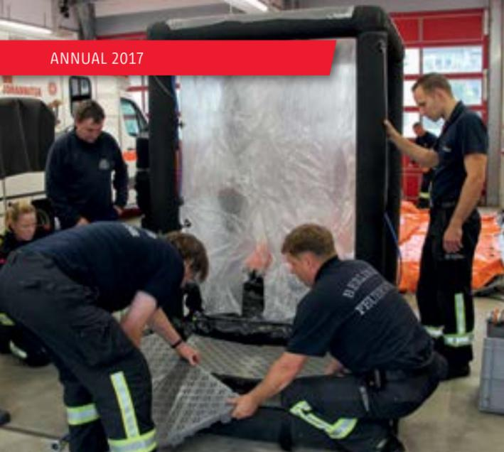
**Aufbau einer Dekontaminationsdusche**
