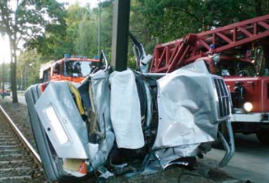
Der PKW hatte sich förmlich um den Oberleitungsmast gewickelt.
