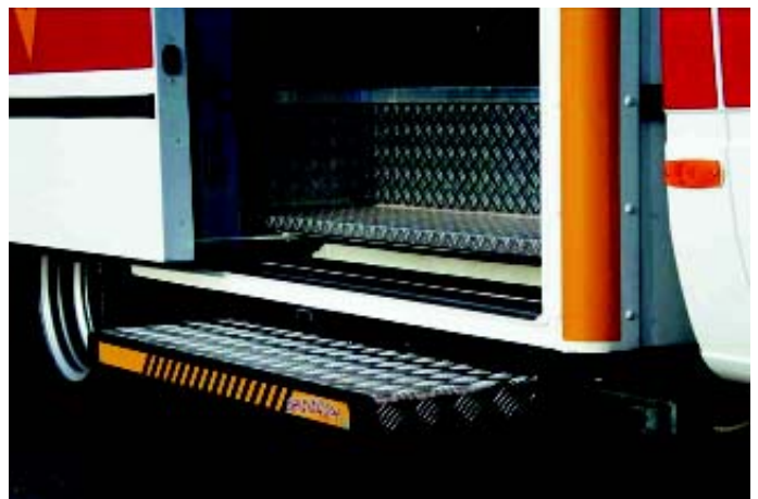
2) Sicheres Ein- und Aussteigen mit elektromechanischem Tritt
