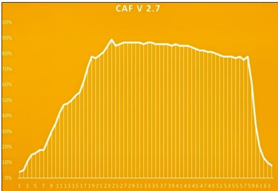
**Diagramm 2:** Verlauf der Wasserdampfbildung bei der Druckluftschäumenanwendung in % der absoluten Luftfeuchte über der Zeit in Sekunden. Bei Druckluftschaum erfolgt ein Anstieg der Kurve, der hohe Wasserdampfgehalt hält über einen deutlich längeren Zeitraum an.
