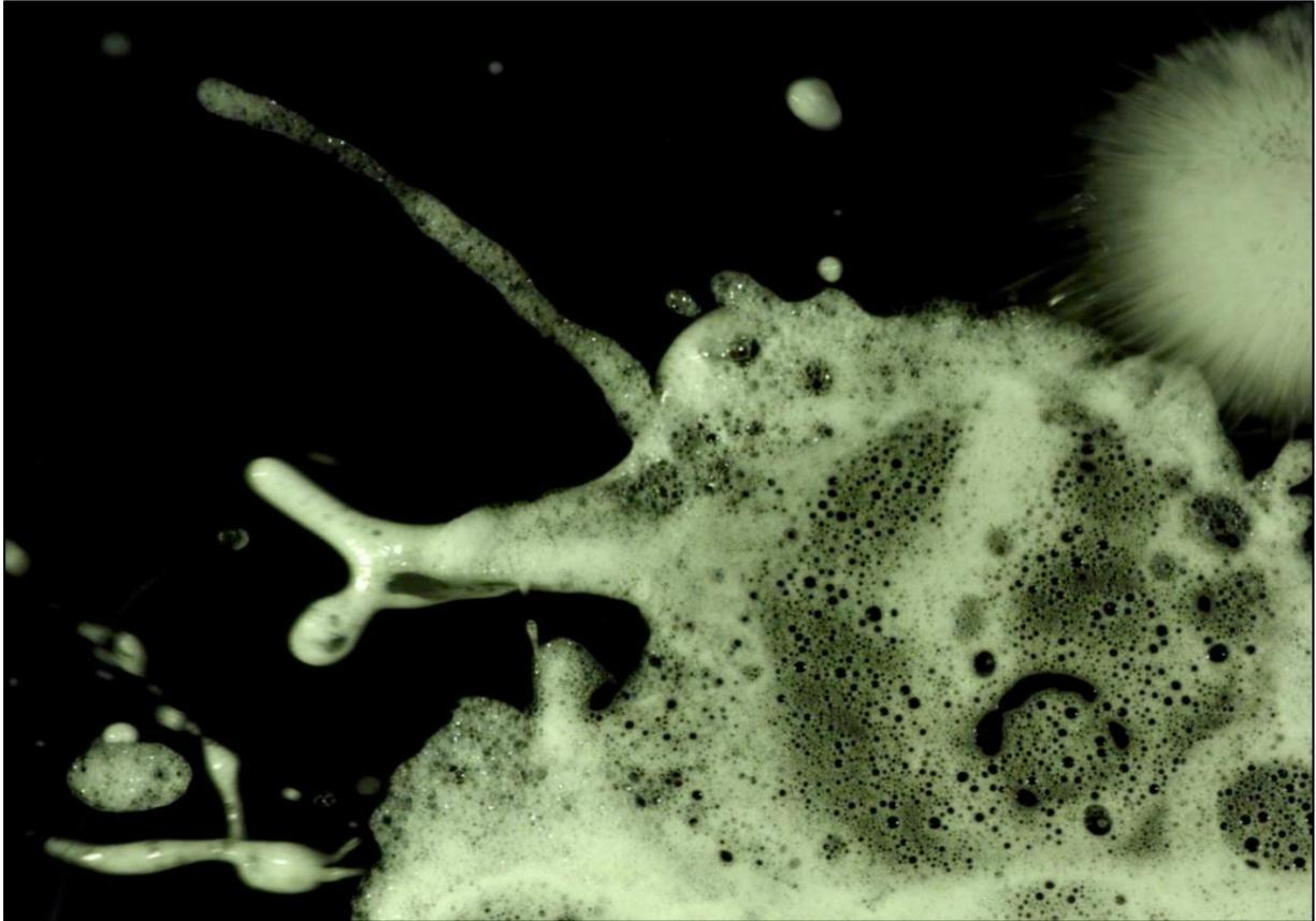
**Abbildung 5:** DLS Applikation auf erwärmte Glasscheibe, aufgenommen mit einer High-Speed-Kamera. Bild: OvGu, 2017.
