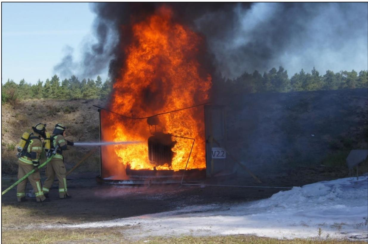
**Abbildung 16:** Transformatoren-Brandversuche mit Druckluftschaum. Bild: Alan Ratajczak, BF Ingolstadt, 2017.
