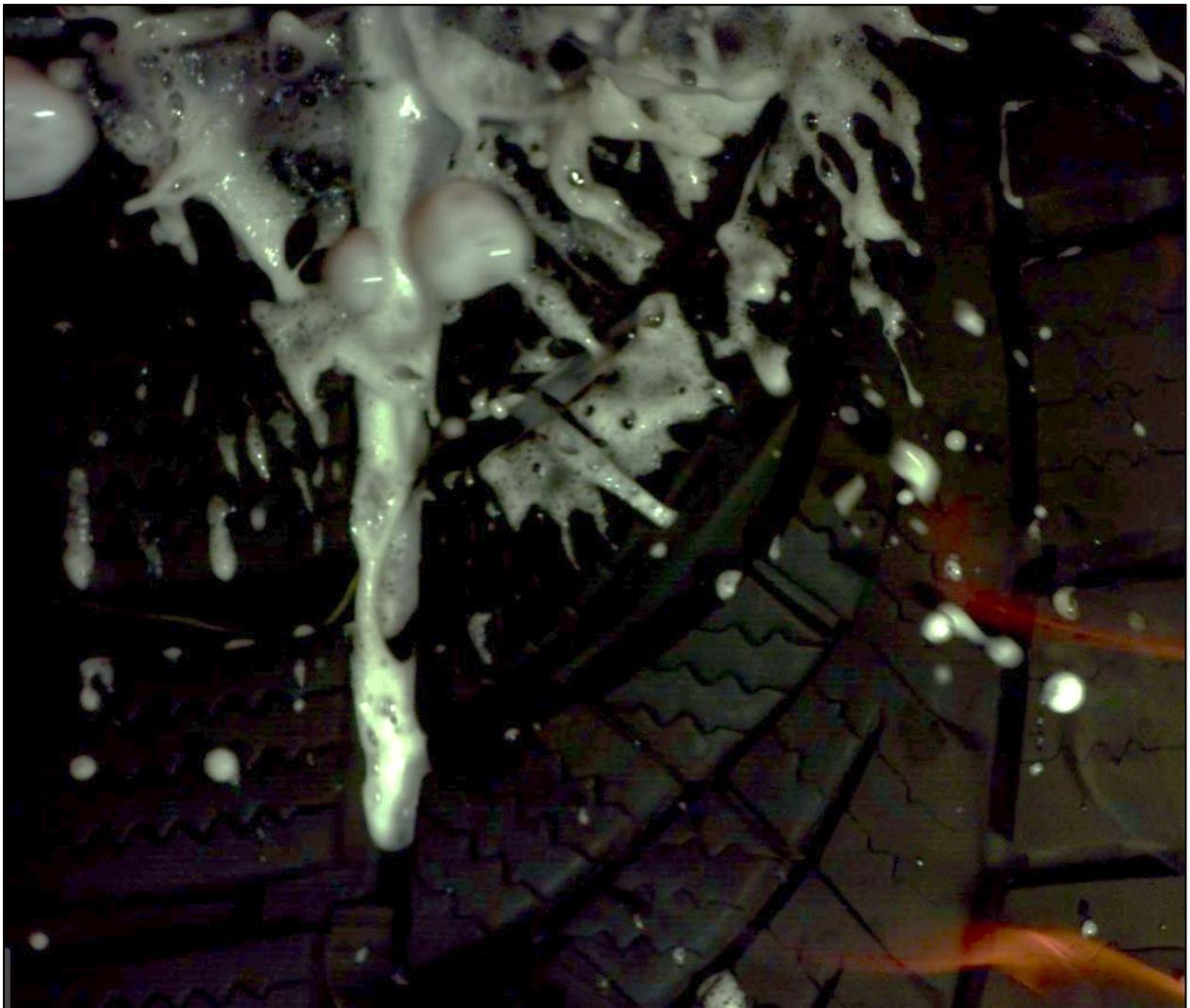
**Abbildung 4:** DLS Applikation auf einen brennenden KFZ-Reifen, aufgenommen mit einer High-Speed-Kamera. Bild: OvGu, 2017.
