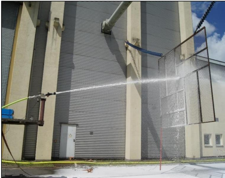
**Abbildung 14:** DLS Applikation auf ein unter Hochspannung stehendes Metallgitter. Bild: Berliner Feuerwehr, 2017.
