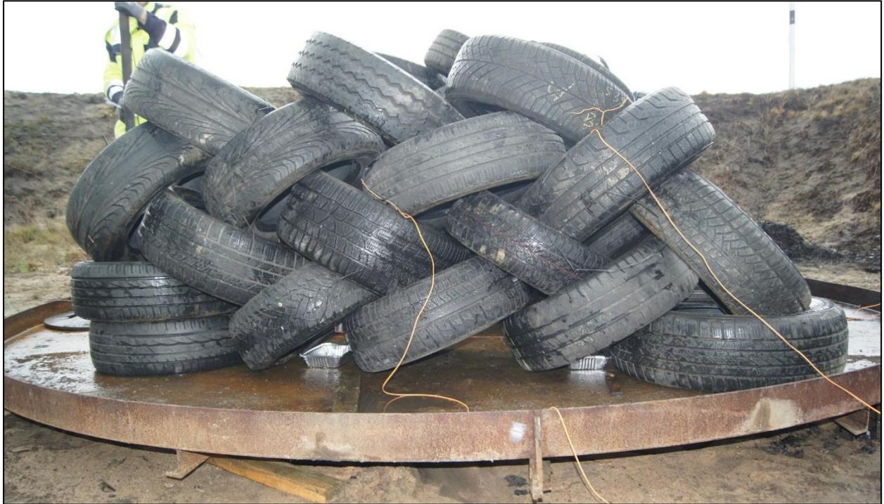
**Abbildung 1:** Versuchsaufbau Autoreifenbrände. Bild: Berliner Feuerwehr, 2016.
